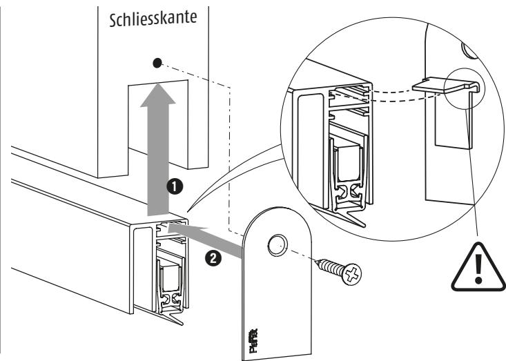
**Montage der Dichtung:** ① Dichtung einlegen; ② Haltewinkel befestigen, ev. vorbohren der Schraubenlöcher
