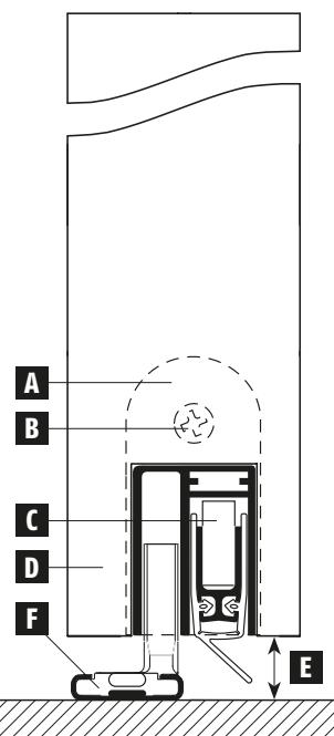
**Verwendungszweck:** Planet-Dichtungen werden in Türen eingebaut und verschliessen die Bodenfuge automatisch. Bitte Anleitung vorgängig lesen.
