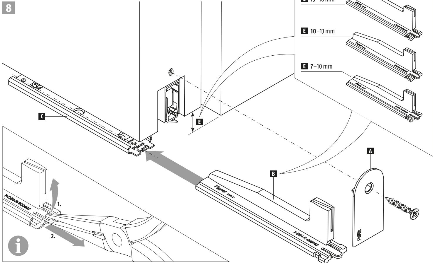
**8a** In der Wand laufend: 1. Schiebetür einhängen und ganz öffnen, 2. Haltewinkel **A** entfernen, Dichtung nach oben drücken, 3. passende Kulissee **B** in Bodenblech **C** einschieben (siehe Bodenluft **E**, Bodenanpressung vermeiden!), 4. Haltewinkel **A** festschrauben, 5. Funktionskontrolle.
