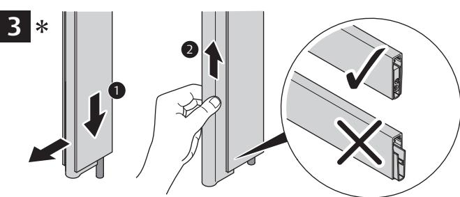
**Absenkabdichtung einsetzen:** ① Dichtlippe ausfahren; ② Dichtlippe durch Massieren auf passende Länge stauchen (bündig mit Dichtungsgehäuse); ③ Werkseitigen Auslösestift aus der Absenkabdichtung herausschrauben; ④ Innenprofilverlängerung in die Absenkabdichtung einsetzen; ⑤ Absenkabdichtung in die Nut einsetzen
