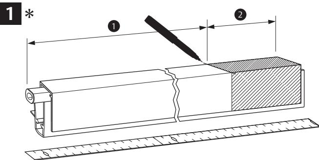
**Vorbereitung zum Kürzen:** ① Dichtung kürzen auf Türbreite minus 18 mm; ② Kürzmaß: bis zur nächsten Lagerlänge (max. 125 mm)
