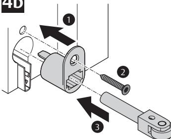
**Befestigen der Dichtung:** ① auf Auslösegegenseite (4a) einen Haltewinkel einsetzen (liegt der Dichtung bei), auf Auslöseseite (4b) das Modul einsetzen; ② Schraubenlöcher vorbohren, Haltewinkel und Modul mit den beiliegenden Schrauben befestigen; ③ rotierenden Aktivator einsetzen
