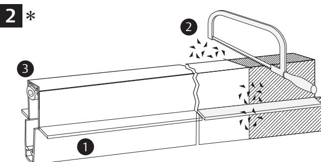
**Dichtung kürzen im ausgelösten Zustand:** ① Dichtlippe ausfahren; ② Dichtung kürzen, Späne entfernen; ③ Funktionskontrolle
