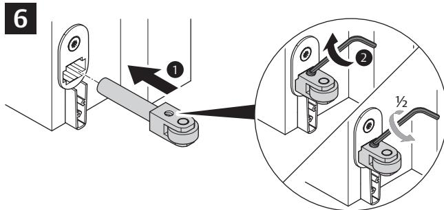
**Aktivator sichern:** ① Aktivator einsetzen; ② Sicherungsschraube mit Innensechskantschlüssel (3 mm) bis zum Anschlag hineinschrauben, dann um eine halbe Schlüsseldrehung lösen.
