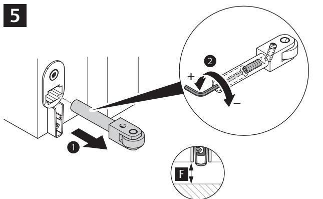
**Hub einstellen:** ① Aktivator entfernen; ② Hub mit Innensechskantschlüssel (3 mm) einstellen, Bodenanpressung vermeiden (siehe Bodenluft F)
